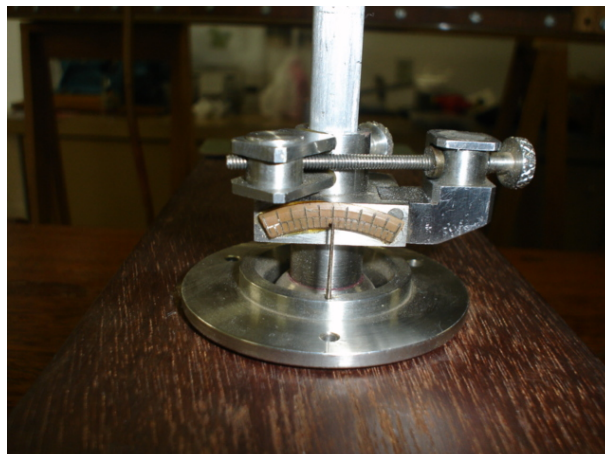
Figura 3. Mecanismo de variação angular da sonda.
